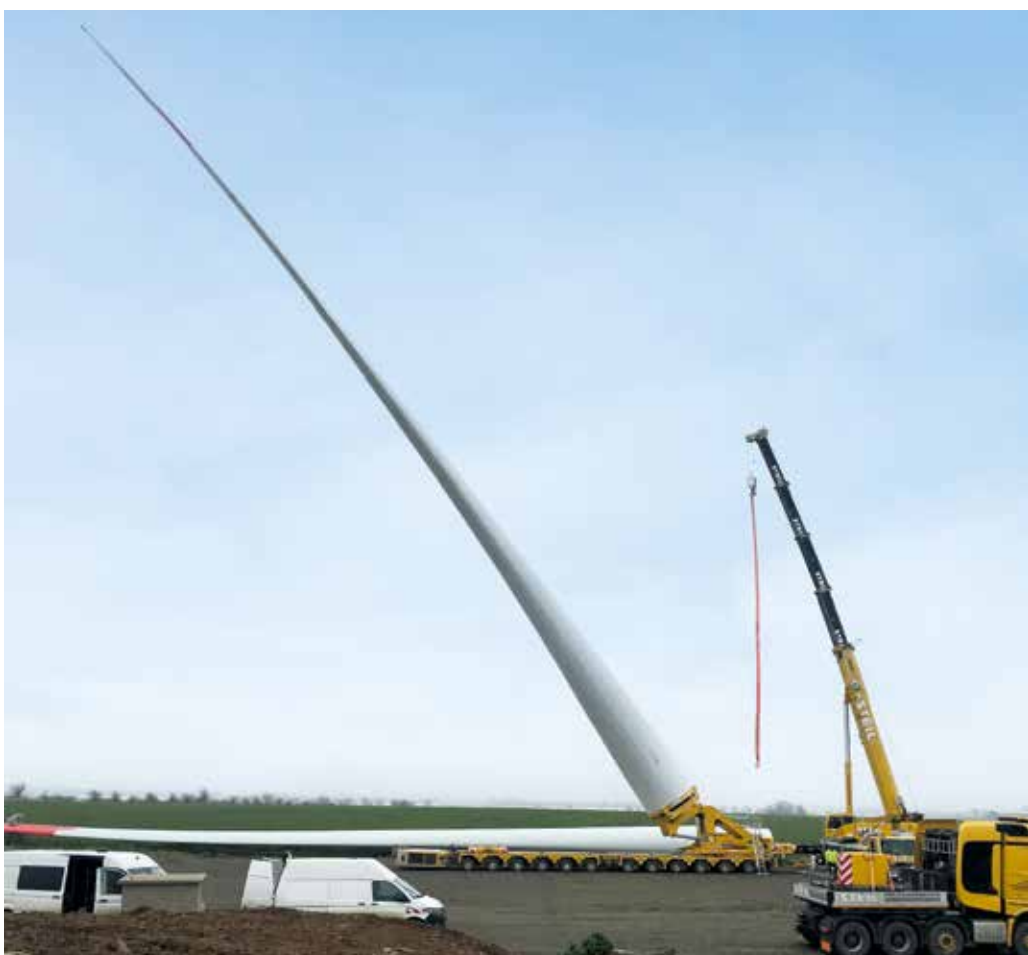
Der Rotorblattadapter G4 von Scheuerle ermöglicht einen Aufstellwinkel von bis zu 60°.
