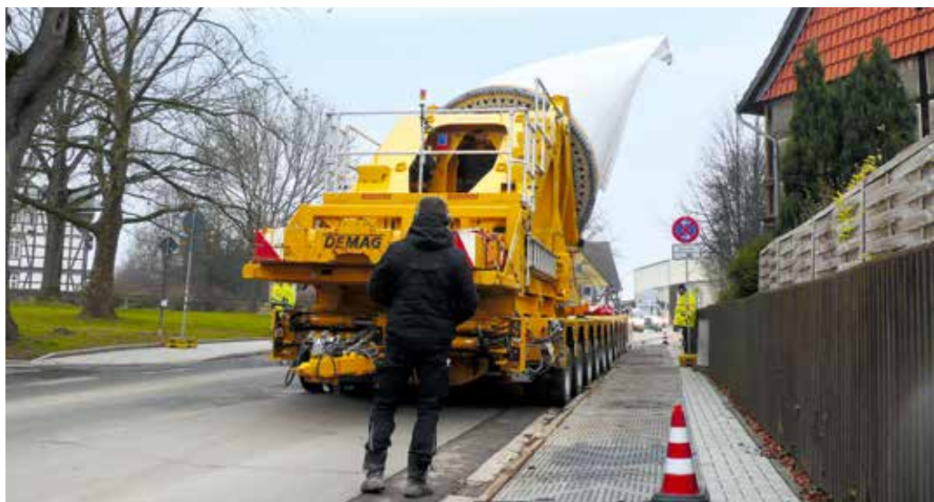
Innerhalb der Ortschaft spielt der Rotorblattadapter dann seine Stärke aus: das Rotorblatt wird aufgerichtet, um so Hindernisse zu überwinden.
