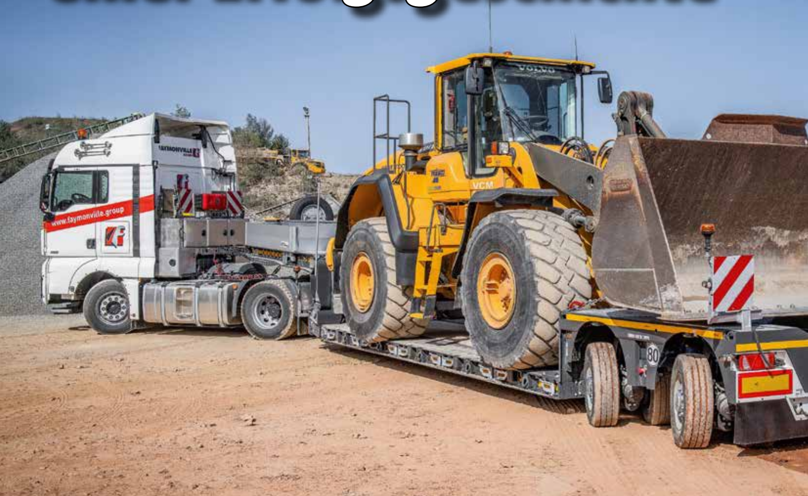
Typisch Pendelachse: Der Lenkeinschlag von bis zu 60° verleiht der Transportkombination optimale Manövrierbarkeit.
