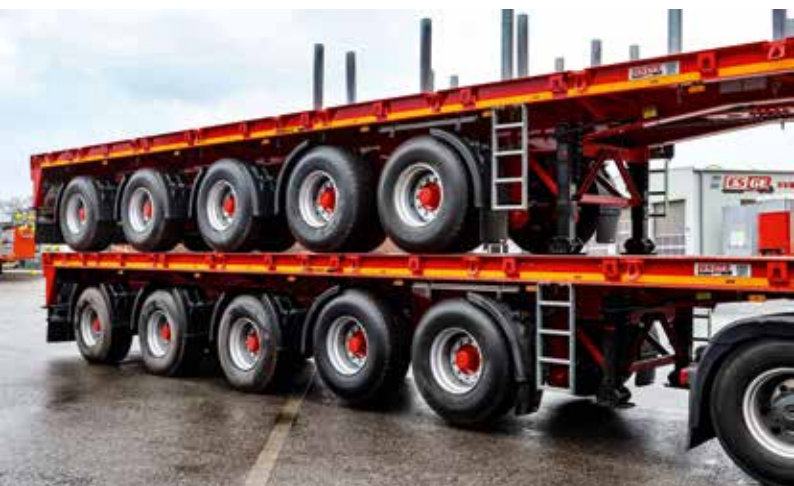
Die ersten beiden Achsen des 5-achsigen Ballastaufliegers sind liftbar.
