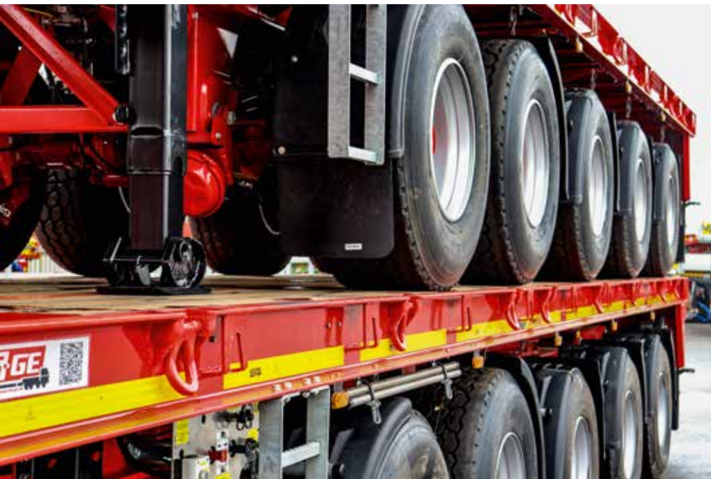
Die Ballastauflieger bieten zahlreiche Verzurrmöglichkeiten unterschiedlicher Bauart, wie beispielsweise Rungentaschen.
