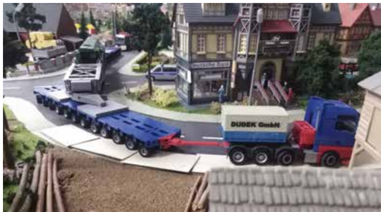
Um die Last besser zu verteilen und den Untergrund zu schützen kamen auch Stahlplatten zum Einsatz.
