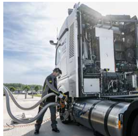
An der neu installierten Prototyp-Tankstelle im Entwicklungs- und Versuchszentrum in Wörth wird der GenH2 Truck betankt.
