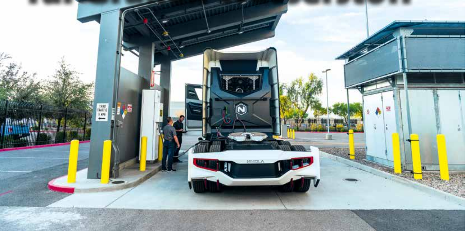
Tankvorgang an der H2-Tankstelle.
