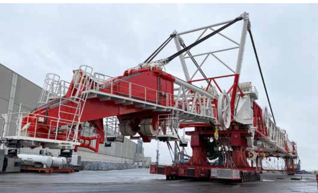
SPMTs transportieren den 120 m langen und 1.500 t schweren Ausleger.
