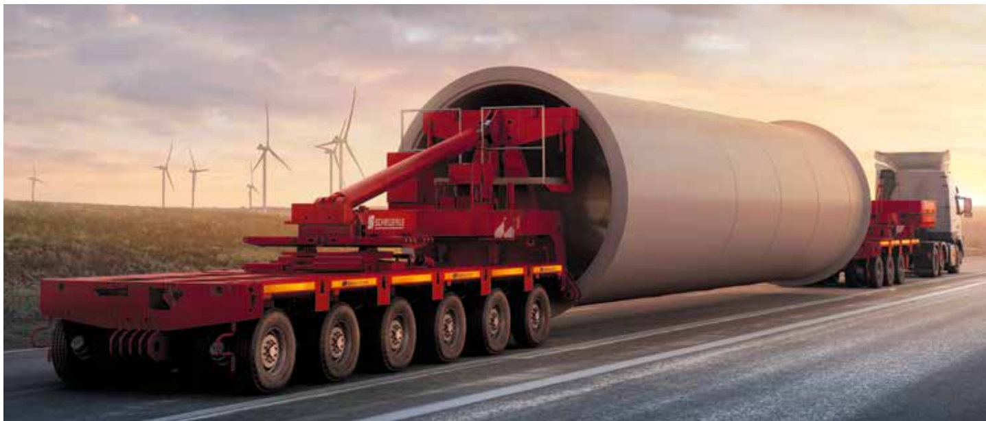
Der Windturmadapter WT70 im Einsatz.
