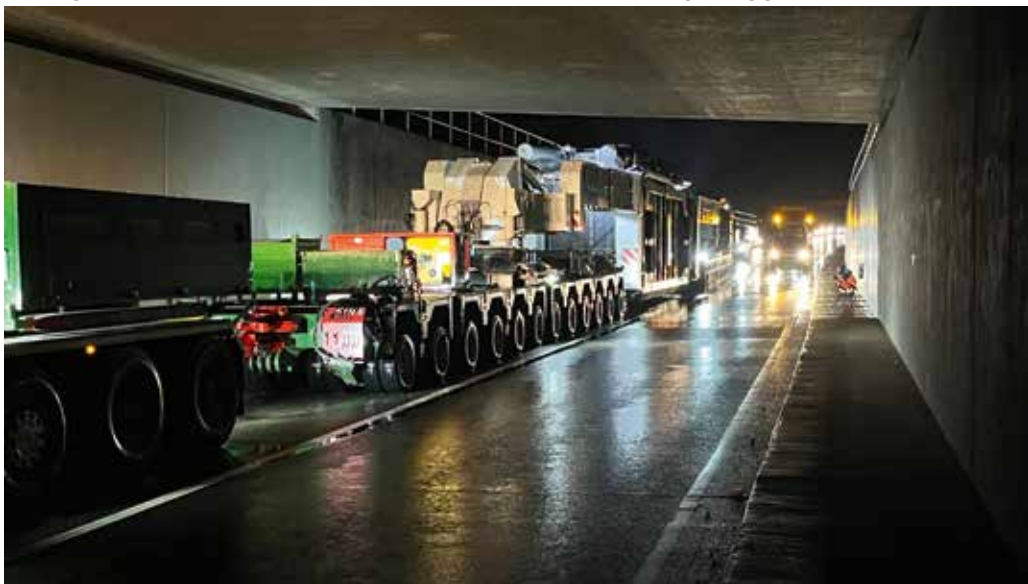
Es mussten Leitplanken, Findlinge usw. mit dem Ladegut überschwenkt, bzw. das gesamte Gespann auch mal durch einen Tunnel durchgeführt werden.
