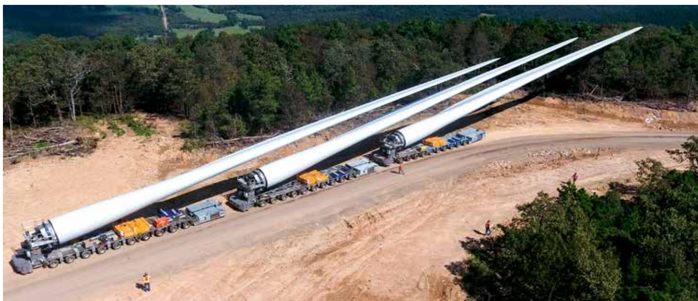
Der Goldhofer FTV 550 beim Windflügeltransport.
