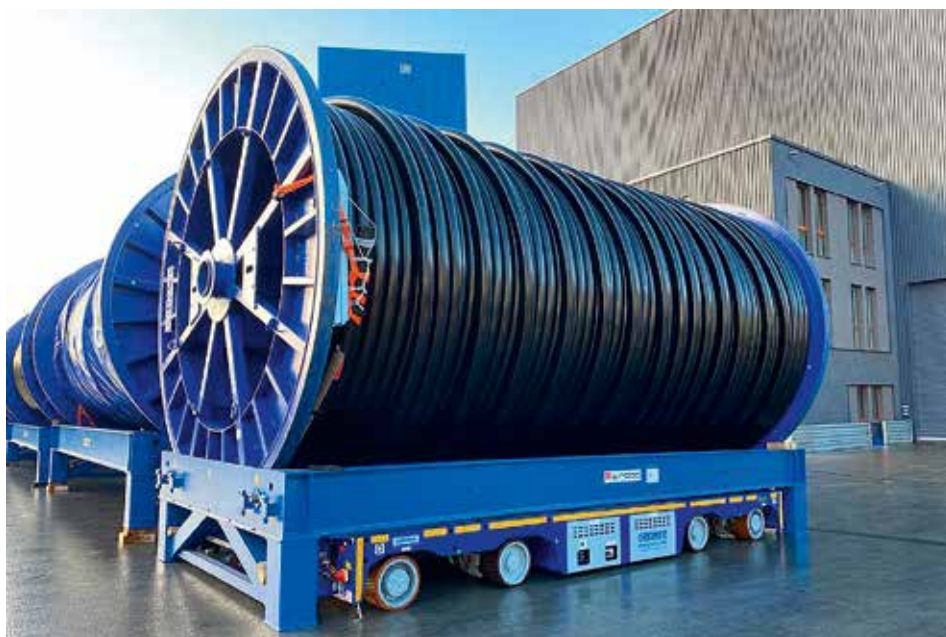
Der NKT-SEFIRO ist unter dem Träger mit der 100 t schweren Kabeltrommel platziert. Nachdem das Gerüst samt Kabeltrommel mit dem SEFIRO angehoben wurde, wurde diese in eine Halle gefahren.
