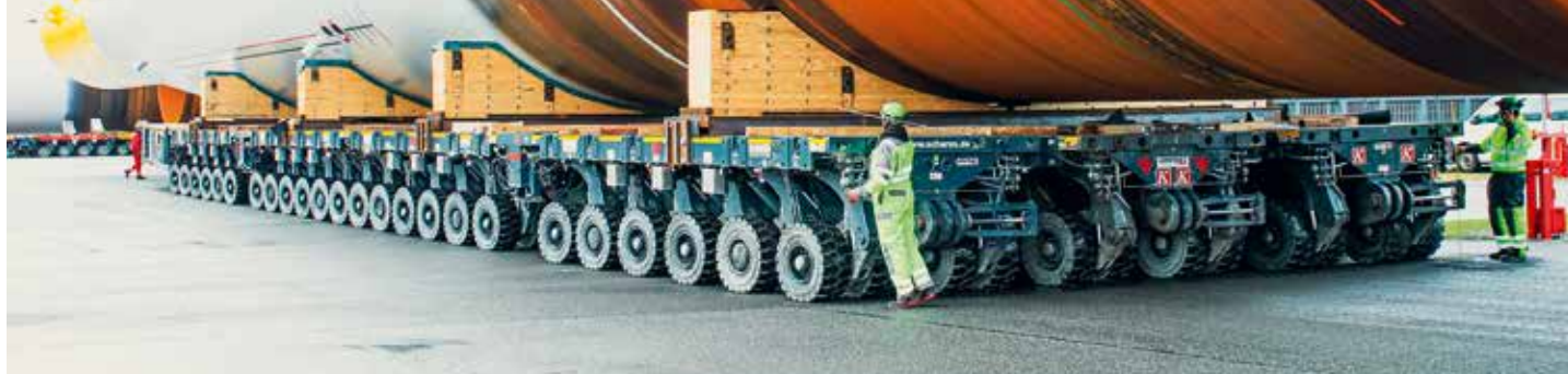
Load-out in Nordenham mit Hilfe von 72 Achslinien Cometto SPMT und drei Power Pack Units mit einer Leistung von je 368 Kilowatt.
