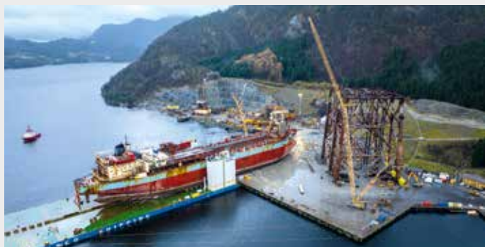
Mit 20.300 t der aktuelle Weltrekord: das beeindruckende FPSO wird an Land gebracht. Bild: Credit AF Gruppen/Woldcam
