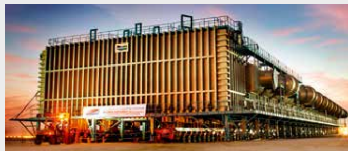
Erhielt im Jahr 2012 einen Eintrag ins Guinness-Buch der Rekorde: der Transport einer 4.891 Tonnen schweren Verdampfungsanlage auf 172 SPMT Achslinien in Saudi-Arabien mit einer Länge von 124 Meter, 34 Meter Breite und 12 Meter Höhe.
