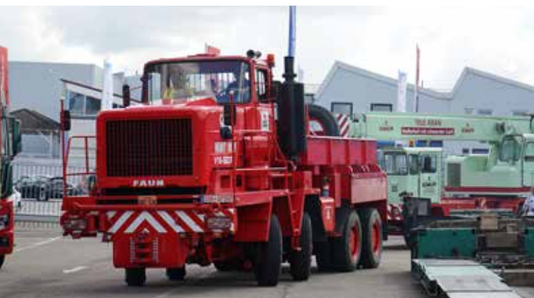
Einer der Hingucker: der Faun HZ 70.80/50W „Gigant“ – die 4-achsige Schwerlastzugmaschine mit V16-Motor und 820 PS und der Faun L1206 mit 450 PS und drei Achsen.
