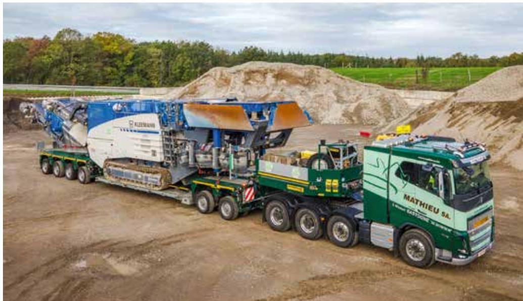
Der 2+4 Tiefflader vom Typ VarioMAX Plus hat einen Brecher geladen.
