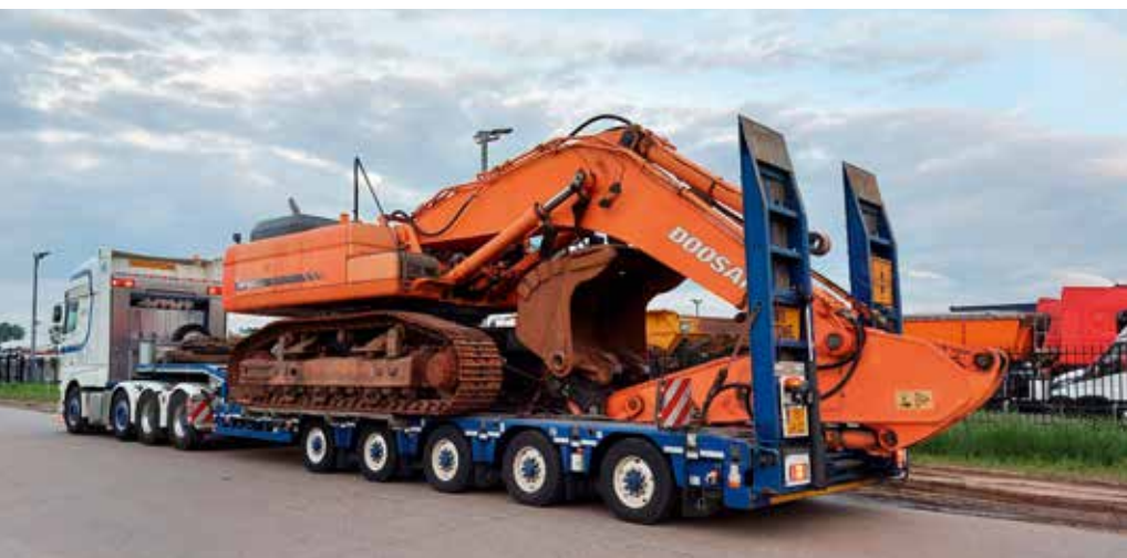
Schwerer Raupenbagger wird auf einem fünfsachsigen Manoovr Semitieflader transportiert.
