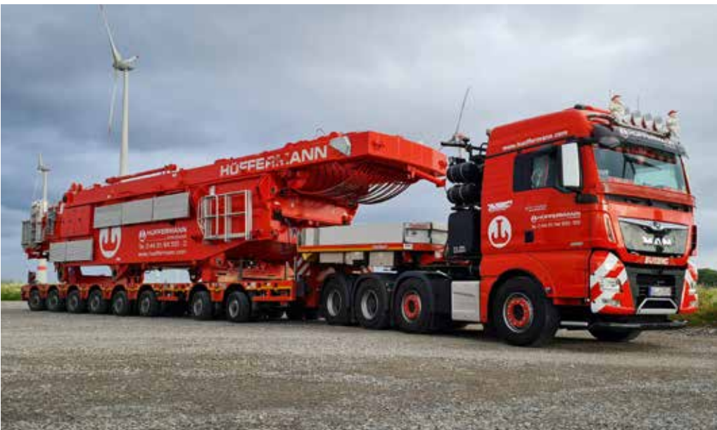
6-Achs-Manoovr Semitiefelader mit 2-Achs Multidolly im Einsatz bei Krandienstleister Hüffermann.
