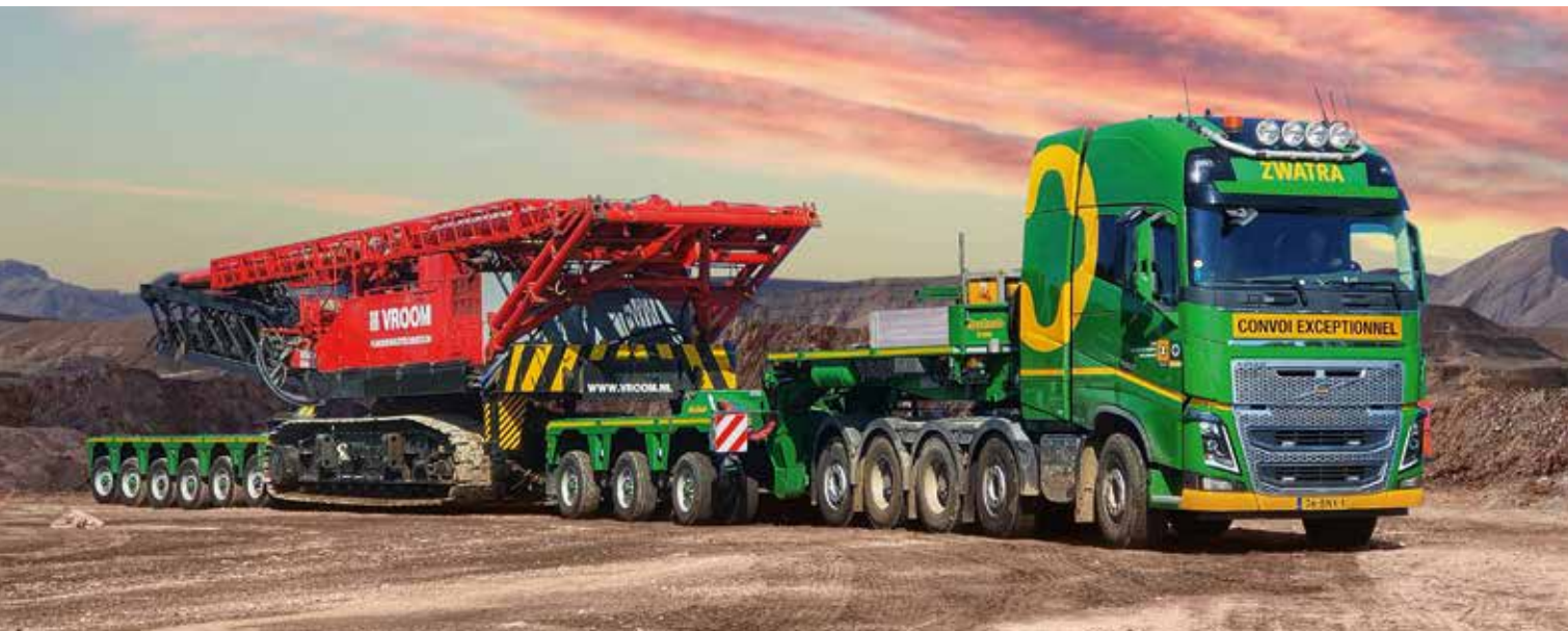
Ein 9-achsiger (3+6) EURO-PX mit schwerem Baggerät
