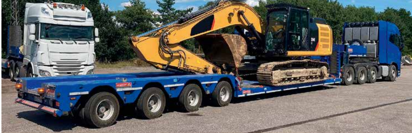
Aus der Langendorf pro-line: SATAH Spezialtieflader mit abfahrbarem Schwanenhals.
