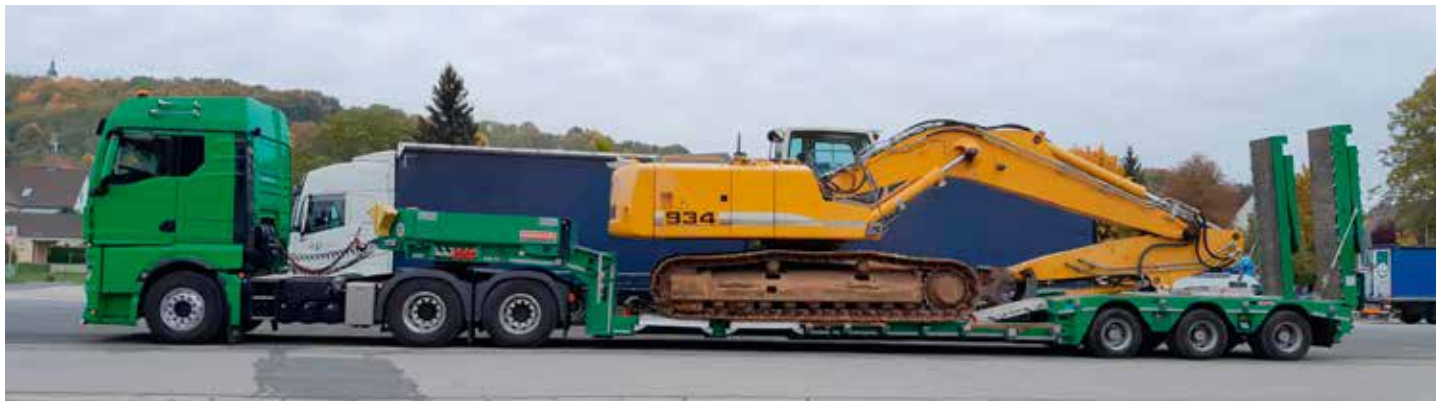
Für den Transport längerer Maschinen: teleskopierbarer Tiefbett-Auflieger Langendorf pro-line SATBÜV mit überfahrbarer Brücke.
