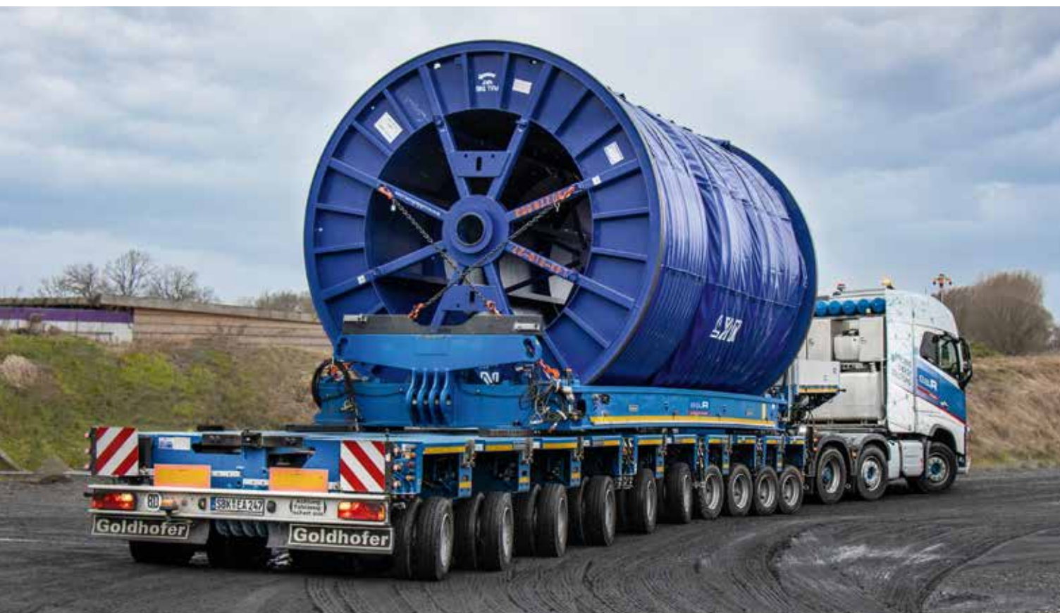
Für engere Baustellenfahrten kann die Kabeltrommelbrücke auch auf dem Plateau verladen werden.
