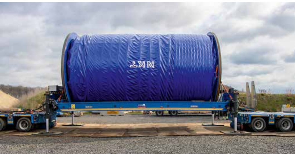
Die Kabeltrommelbrücke lässt sich hydraulisch anheben.
