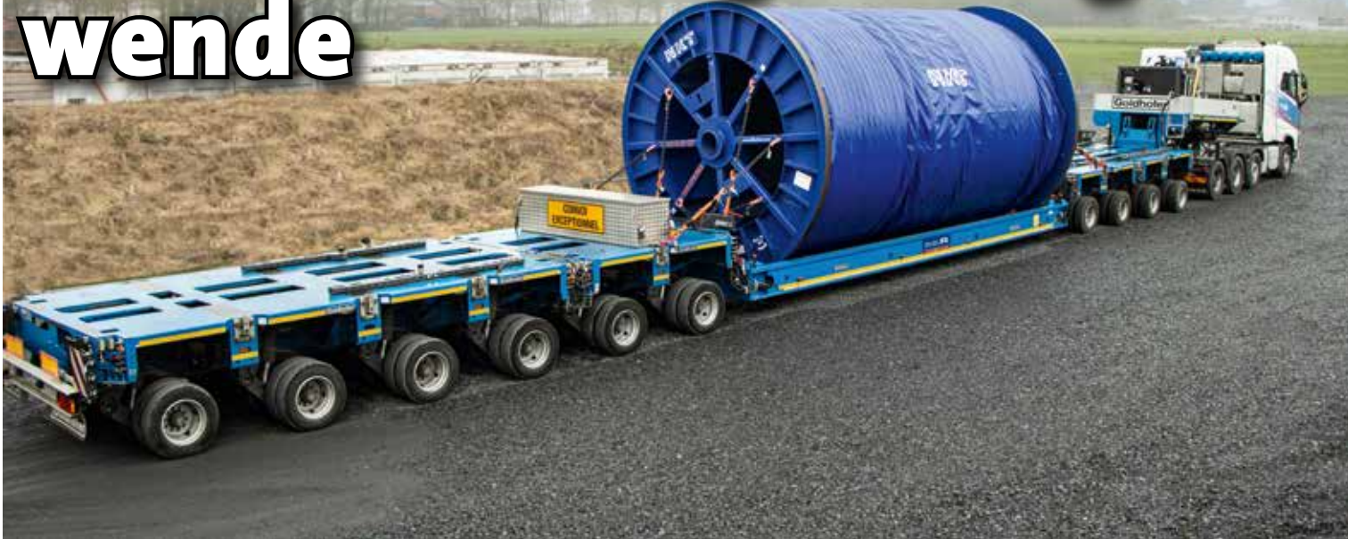
4+6 Schwerlastkombination im Einsatz mit der neuen Kabeltrommelbrücke.
