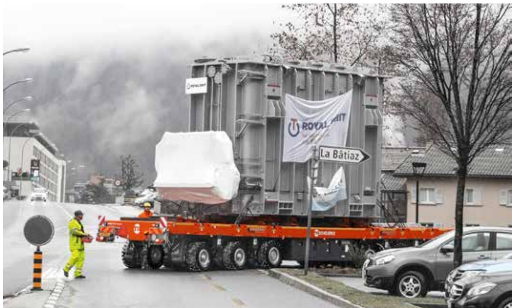
Flexible Fahrstreckenwahl: Zunächst beförderte Friderici Spécial zwei Transformatoren mit Gewichten von 100 und 147 Tonnen.
