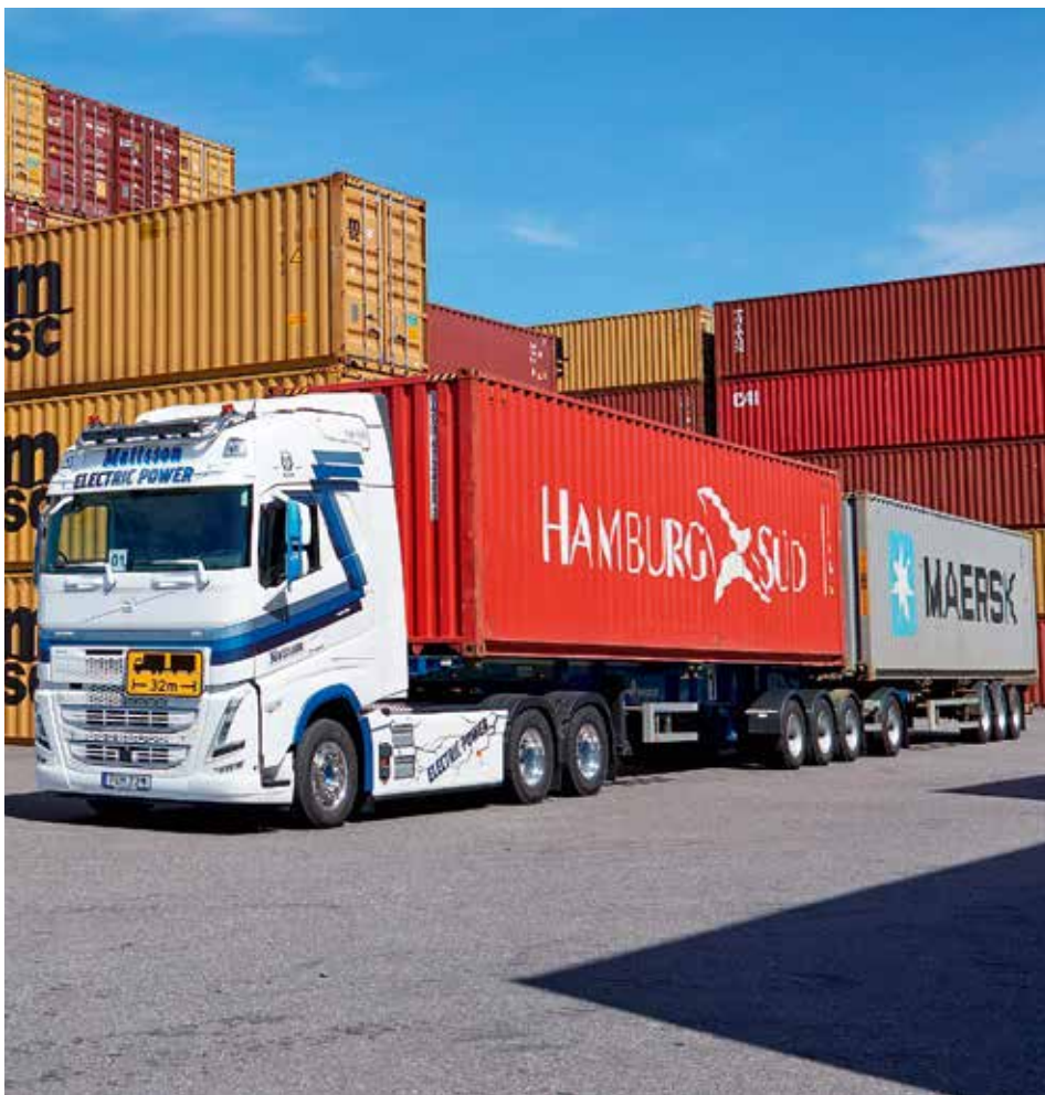
Bei dem HCT-Projekt bringt es der Volvo FH Electric 6x4 auf 32 m Gesamtlänge und kann ein Gesamtzuggewicht von 74 Tonnen bewältigen.
