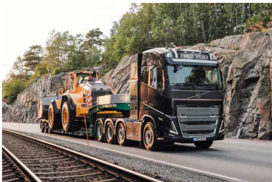
Der Volvo FH16: Kraftprotz mit 325 t maximalem Gesamtzuggewicht und I-Shift.
