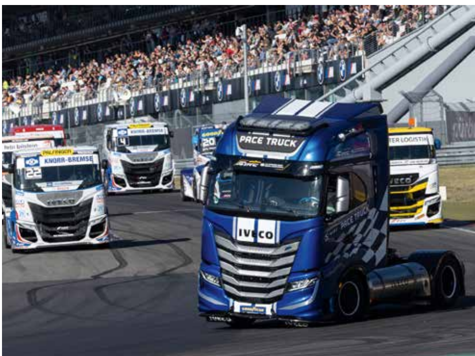
Der IVECO S-WAY LNG Pace Truck fährt mit Bio-LNG.
