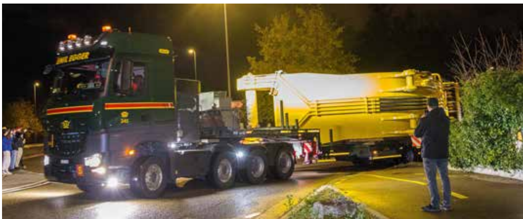
Der Ausleger musste umgelegt werden für den Transport, sonst wäre keine Autobahnfahrt möglich gewesen.
