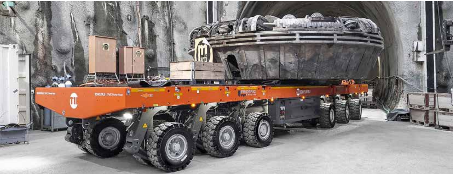
Tunneleinfahrt: 6-Achs SCHEUERLE SPMT PowerHoss befördert Bauteile einer Tunnelbohrmaschine unter beengten Platzverhältnissen.
