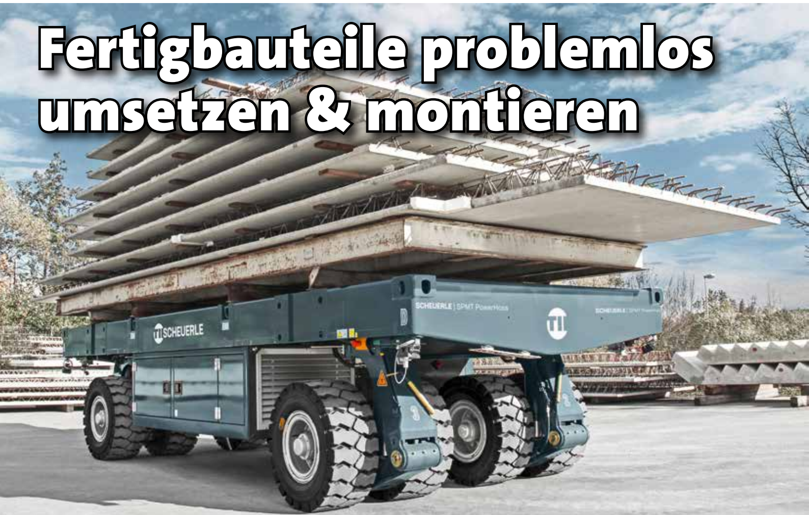
2-Achs SCHEUERLE SPMT PowerHoss befördert Beton-Bauteile.
