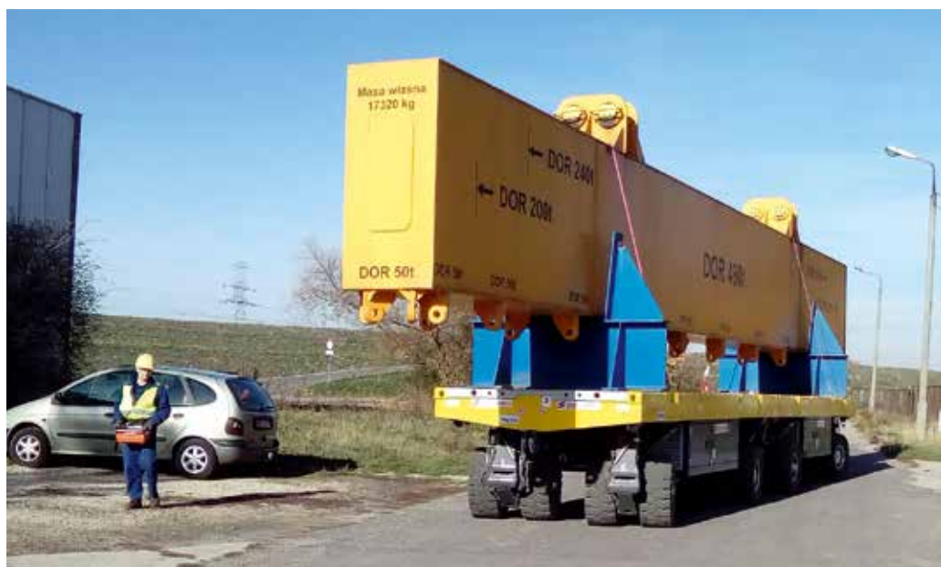
Flexibel konfigurierbar: 2 x 2-Achs SPMT PowerHoss manövrieren Stahlträger-Segmente.
