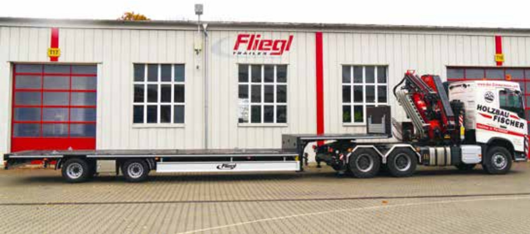
Die neue Kombination der Holzbau Fischer GmbH: 3-Achs-Sattelzugmaschine mit Ladekran und 2-Achs-Pritschensattelaufleger.
