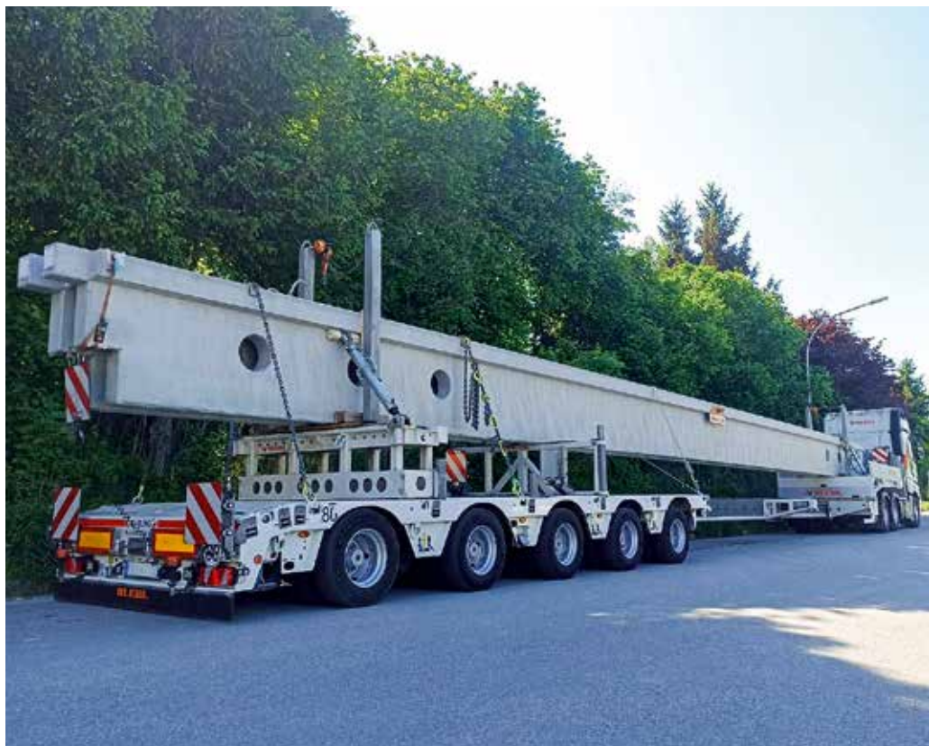
Der MultiMAX von Faymonville beim Transport eines sehr langen und schweren Betonfertigteils.
