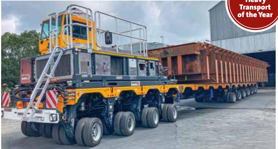
Der 10-achsige Selbstfahrer vom Typ ModulMAX SP-E bietet bis zu 250 t Nutzlast.
