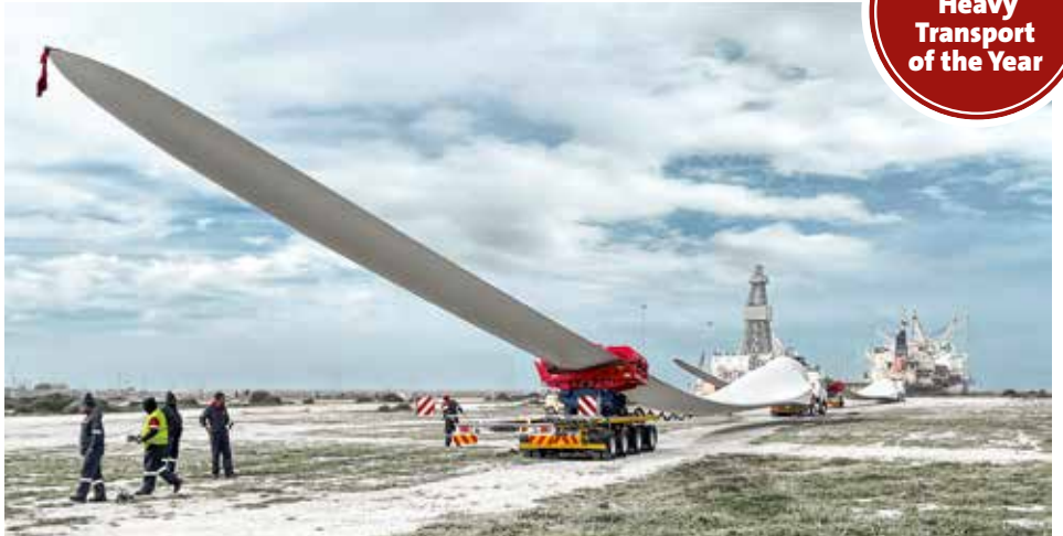
Im Konvoi: zwei TII SCHEUERLE RBTS jeweils bestückt mit einem 83 m langen Rotorblatt.
