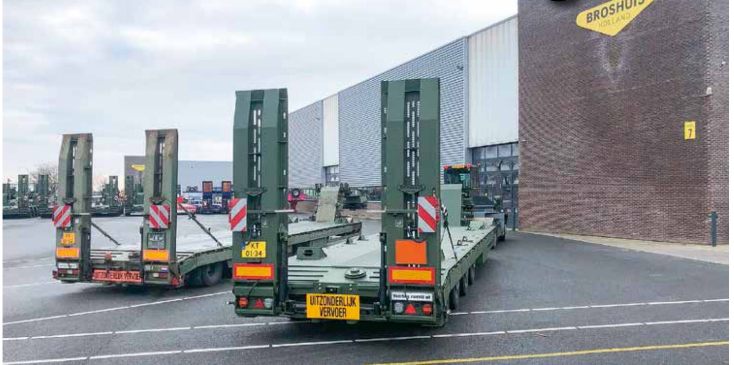
Ein Auflieger vor (links) und ein bereits generalüberholter (rechts) im Vergleich.
