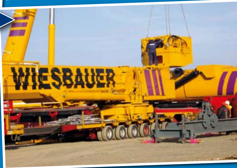
Anbringen der Winde am Oberwagen des GMK 7450. Sie ist größer als die des „Standard“-GMK 7450 und fungiert auch als Gegengewicht. Foto: Marco Wilhelm
