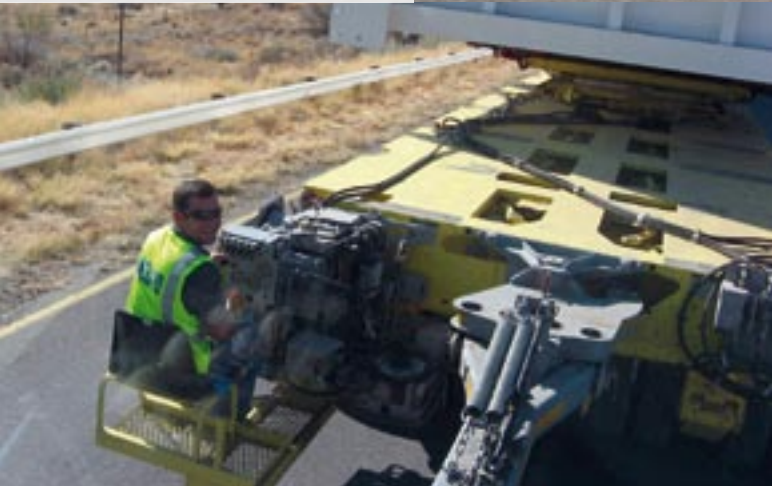
▲▼ Ständig mussten extreme Seitenneigungen ausgeglichen werden, was jedoch über den hydraulische Niveauregulierung der Goldhofer-Fahrzeuge kein Problem darstellte.
