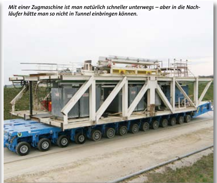
Die beiden insgesamt 510 t schweren Nachläufer mussten zum Bohrkopf, der sich schon im Tunnel befindet, transportiert werden.
