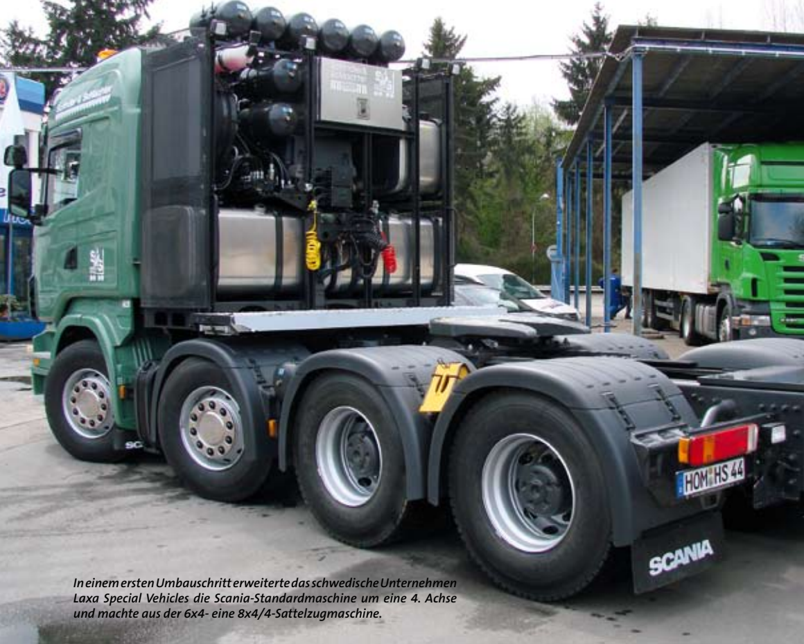
Die Wandlerkühlung wurde von Laxa Special Vehicles unter anderem mit zwei 500 l-Treibstofftanks, einer zusätzlichen Kompressoranlage für die gezogenen Einheiten sowie der Batterie im Schwerlastturm untergebracht.
