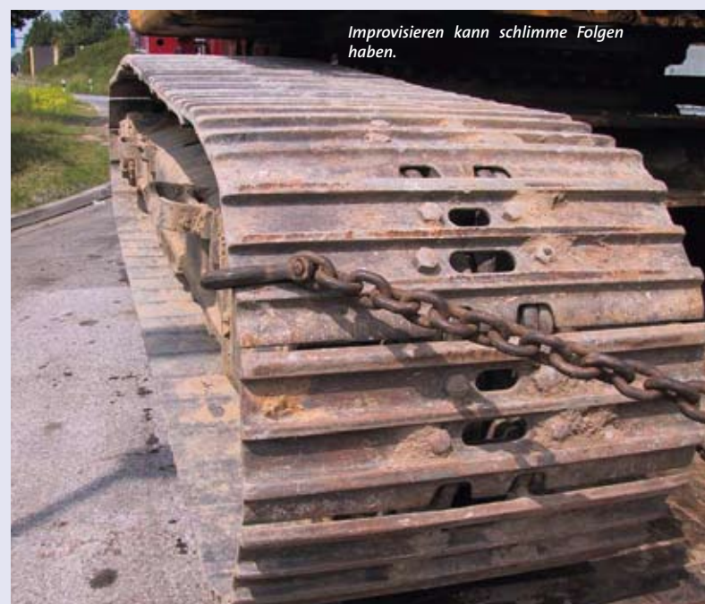
Hier wurde der Raupekettenträger mit einer Kranzkette umschlungen.
