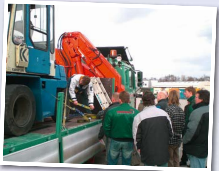
Anschauungsunterricht am Lkw: Direktverzurrung eines Gabelstaplers.
