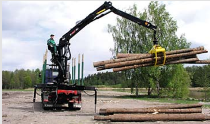
Hiab zeigt auf der IAA 2008 ein breites Sortiment von maßgeschneiderten Lkw-Ladekränen mit Hubkapazitäten von 1 bis 92 mt und Reichweiten zwischen 2 und 30 m. Auch die Produktgruppen Loglift und Jonsered werden sich auf der IAA in Hannover präsentieren und Krane zum Holztransport und Holzumschlag sowie neue Modelle für den Schrott- und Recyclingbereich vorstellen (im Bild: Loglift F 115Z).
