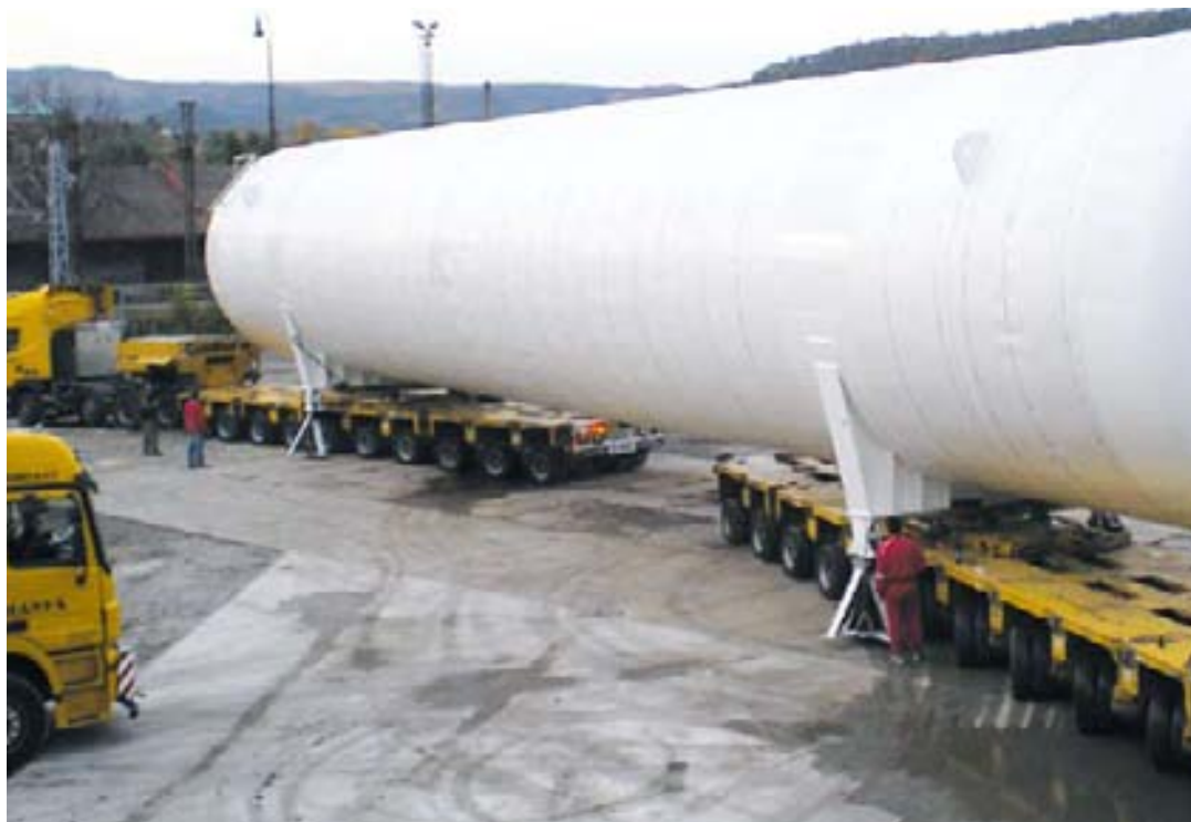
Einsatz einer Goldhofer Schwerlastkombination im Nachläuferzug beim Transport eines circa 40 m langen und circa 4,5 m Durchmesser umfassenden Kessels. Foto: Hanys
