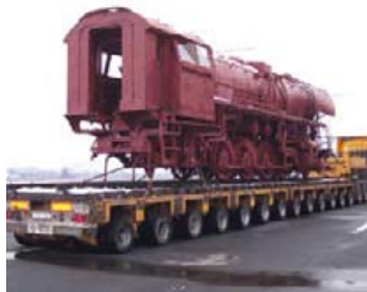
Transport einer Nostalgie-Lokomotive auf einer 13-achsigen Schwerlastkombination. Foto: Hanys
