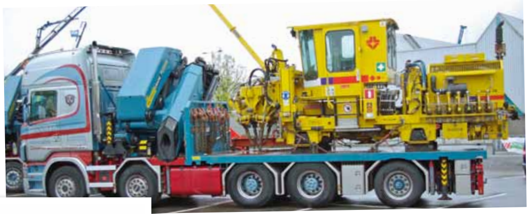
Die für die Niederlande so typischen 5-Achser bieten auch mit dem schwersten aller Pfalfinger-Ladekrane, dem PK 150002, noch genug Ladekapazität, um eine 11 t schwere Gleisbaumaschine zu transportieren und sie an nahezu jedem beliebigen Ort auf die Schiene zu setzen.
