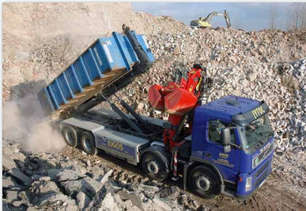
„Doppeltes Lottchen“: Volvo FM12 mit Palift-Abrollkipper und Epsilon-Kran.
