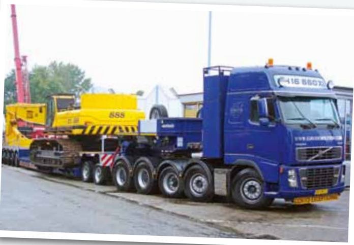
5-achsiger 660 PS-Volvo FH 16 mit einer Nootboom-Tiefbettkombination in edlem Blau.
