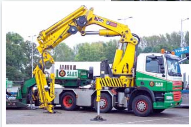
Zum Betätigungsfeld von Saab zählen auch Flugzeugtransporte. Unter anderem mithilfe eines Hiab 800 HI PRO-Ladekran auf einer 4-achsigen Sattelzugmaschine werden ausgediente Jets ins Museum transportiert und dort als Exponat an der Decke aufgehängt.
