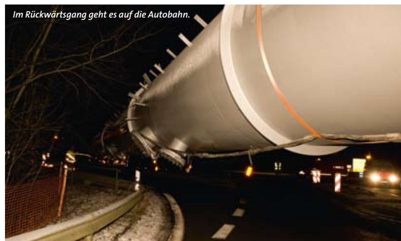
Überhang: das Ende der Butankolonne ragt deutlich über die Leitplanke hinaus.
