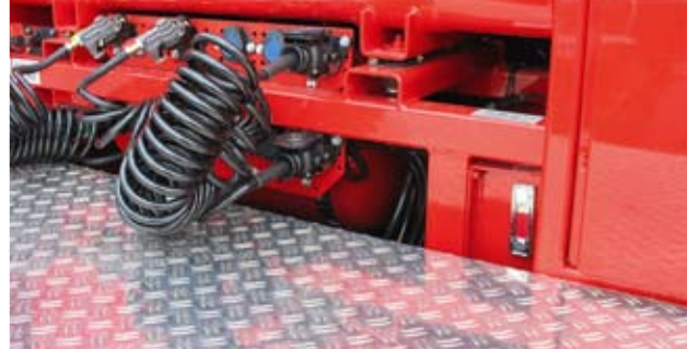
◀▶Umfangreiche Umbaumaßnahmen: Sämtliche Anschlüsse müssen von der Fahrerkabine hinter den Schwerlastturm verlegt und die Serien-Parabelfedern der Lenkachse ausgetauscht werden, um Platz zu schaffen für die Vorlauflenkachse.
