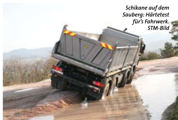
In puncto Verschränkungsfreiheit offenbaren sich hier Offroad-Qualitäten. STM-Bild
