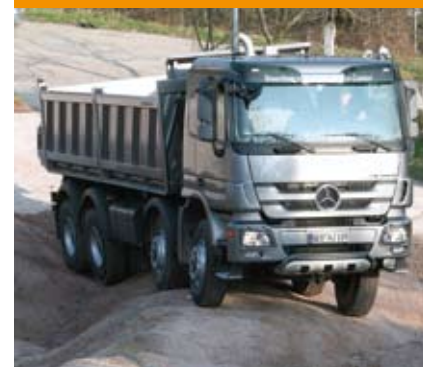
Der neue Actros Bau kann jetzt optional mit PowerShift Offroad ausgestattet werden. Die Schaltautomatik ist eine interessante Alternative zur serienmäßigen Telligent-Schaltung. STM-Bild
