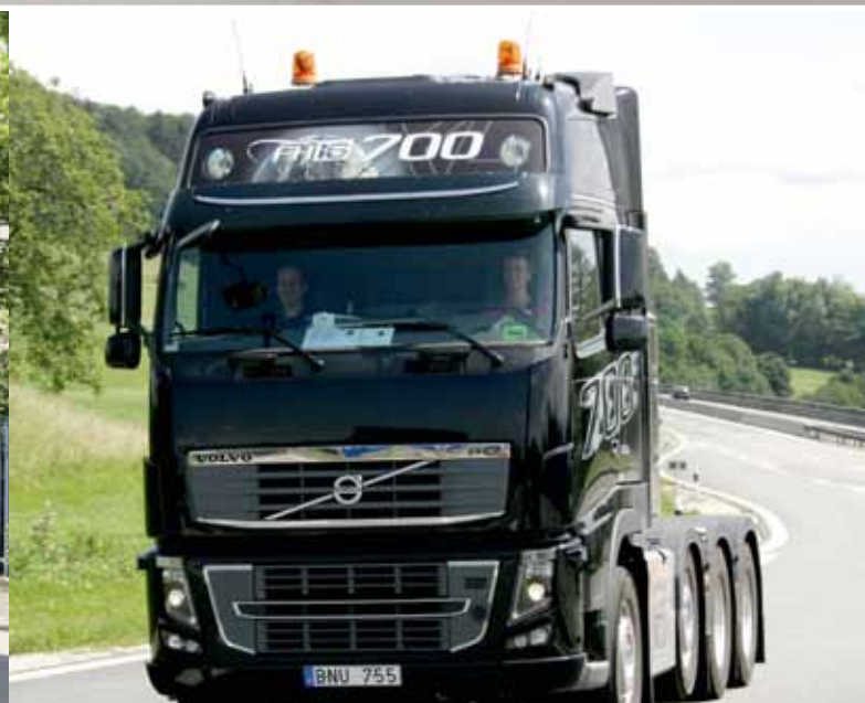
Die Schwerlastzugmaschine war leider solo unterwegs. Trotzdem ließ es sich unsere STM-Redakteurin nicht nehmen, einen Teil der Strecke mit dem 4-Achser zurückzulegen. Den Schaltvorgängen war allerdings anzumerken, dass die Schaltelektronik auf Schwerlastbetrieb eingestellt ist. Ohne Einschränkungen lässt Volvo die Schwerlastzugmaschine für Gesamtzuggewichte von bis zu 170 t zu. Bild: Volvo/ K.S.
