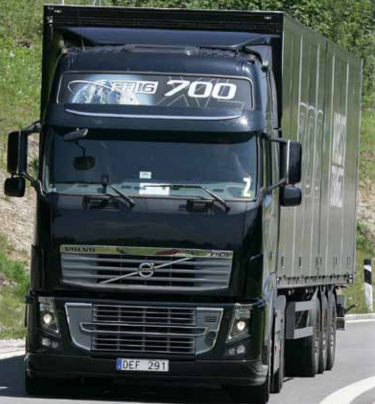
Den verbrauchsgünstigsten Drehzahlbereich erreicht der 700 PS (515 kW) starke Motor des FH16 bei 1.150 bis 1.300 U/min. Bild: Volvo/ K.S.
