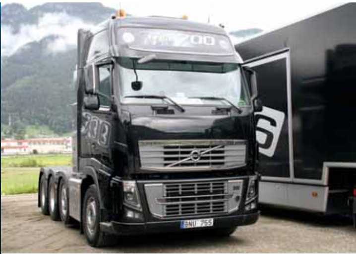
Die Schwerlastzugmaschine ist mit gelenkter Vorlaufachse ausgerüstet (8x4 T). Zusätzlich zur Motorbremse VEB+ ist dieses Fahrzeug mit einem Retarder ausgerüstet. STM-Bild
