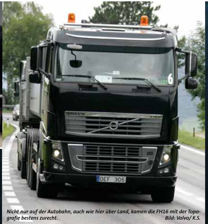
Die Schwerlastzugmaschine ist mit gelenkter Vorlaufachse ausgerüstet (8x4 T). Zusätzlich zur Motorbremse VEB+ ist dieses Fahrzeug mit einem Retarder ausgerüstet. STM-Bild
