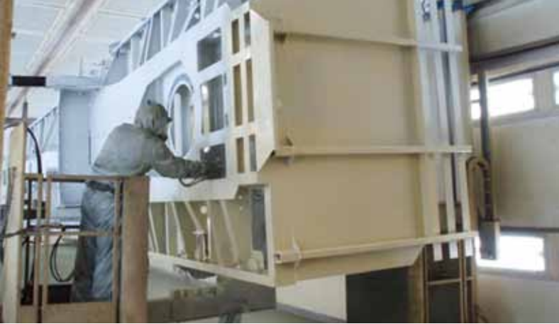
Nach dem Verzinken geht es mit Primern weiter.
