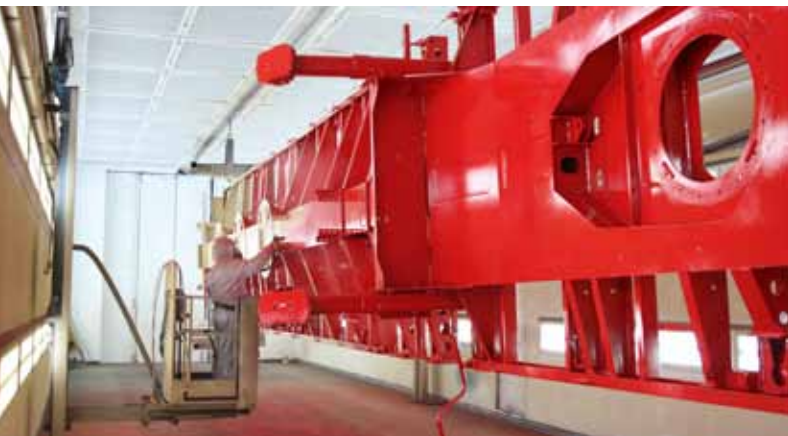
Erst, nachdem die Fahrzeuge gründlich vorbehandelt worden sind, werden sie lackiert.
