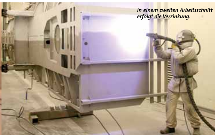
Zunächst werden die Fahrzeuge gründlich gesandstrahlt.
