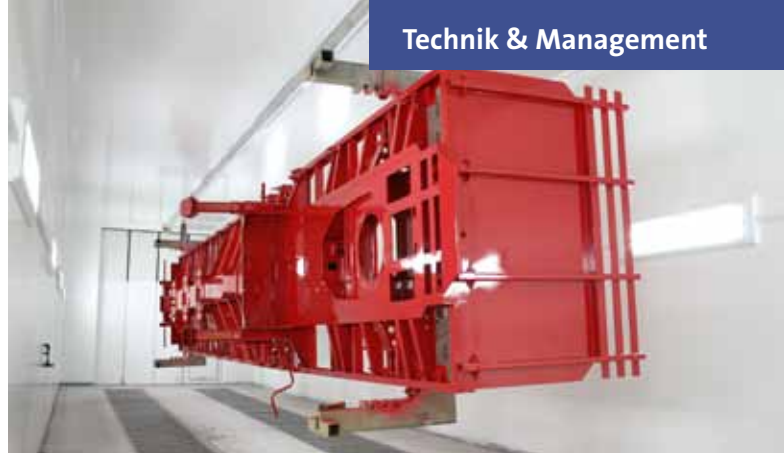
Das frisch lackierte Fahrzeug wird getrocknet.
