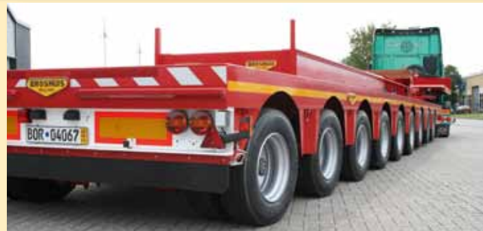
Mit diesem 9-Achser werden auf einem speziellen Transportgestell großvolumige und schwere Blöcke transportiert.
