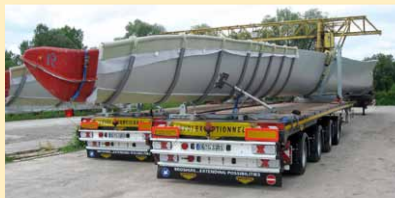
Für den effizienten Transport von Rotorblättern wurde in Zusammenarbeit mit der Spedition Gutmann dieser Triple Wing Carrier konstruiert.
