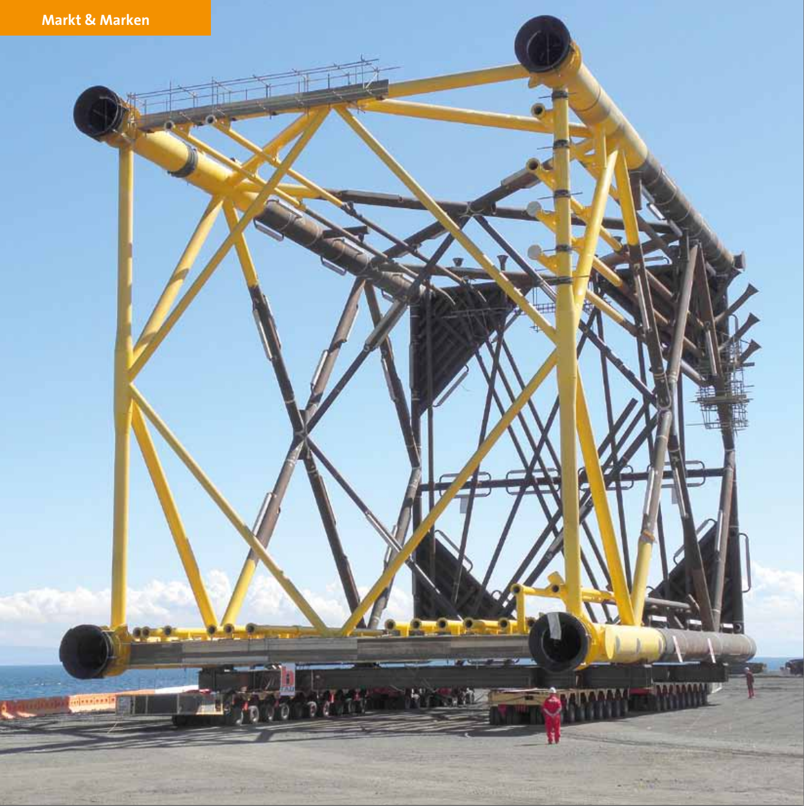
▲▼ Einsatzfeld Windkraft: Ob überdimensionierte Gondeln oder Gründungsgerüste für Offshore-Windenergieanlagen – immer öfter erfordert die Windkraft den Selbstfahrereinsatz.
