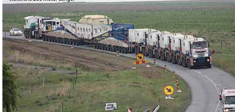
Zusammen mit sechs Zug-/Schubmaschinen bringt es die Kombination auf stattliche 160 Meter Länge.
