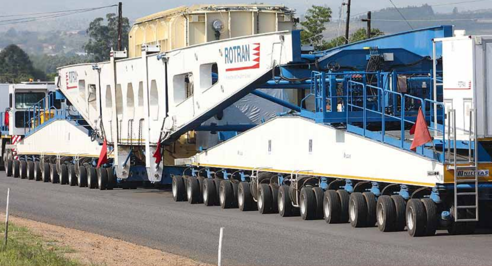
Ein 24-Achser Nicolas nimmt die Last des Transformators auf.
