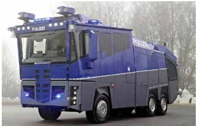
Das futuristisch anmutende Fahrzeug mit der Bezeichnung „Wasserwerfer 10 000“ basiert auf einem 3-achsigen Mercedes-Benz Actros 3341 mit Allradantrieb. Die Kabine stammt von der Rosenbauer International AG.
