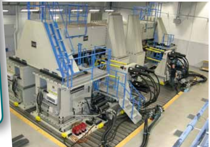
Die neue Testanlage befindet sich im Volvo Werk in Göteborg, Schweden. Im Zeitraum von nur wenigen Wochen kann sie die Belastungen simulieren, denen ein Lkw über seine gesamte Lebensdauer hinweg ausgesetzt ist. Entsprechende Tests in der vorherigen Anlage dauerten viermal so lange.
