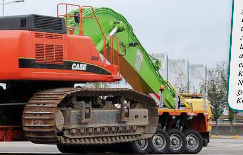
Der PX2 Pendel-X Tieflader von Nootboom erreicht in Fahrtstellung eine Fahrgstellhöhe von nur 1.100 mm und ist jetzt auch mit SAF-Achsen lieferbar.
