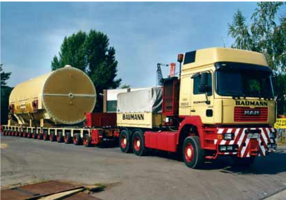
Der Transport verlässt das Hafengelände und biegt dank großem Lenkeinschlag der Goldhofer Achsen problemlos auf die öffentliche Straße ein.
