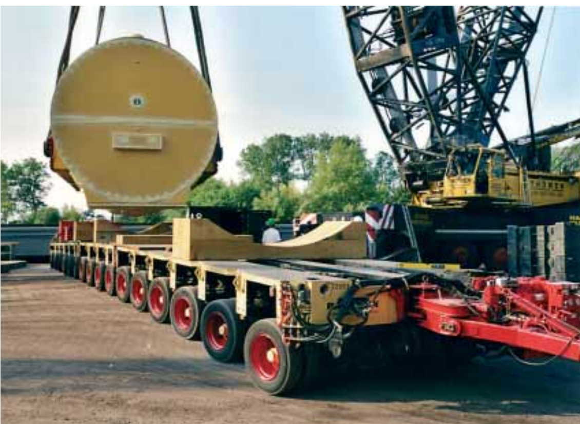
Verladung des 380 t-Generators durch zwei 800 t-Gittermastkrane auf die bereitstehenden 16 Achslinien Goldhofer THP/SL.
