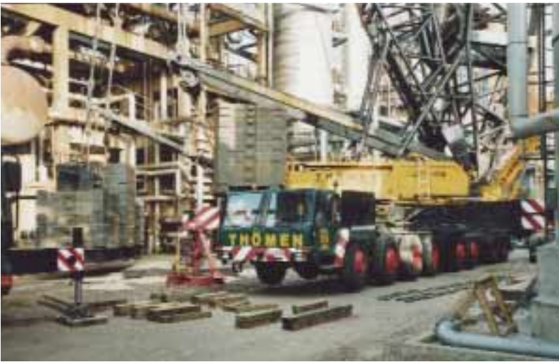
Raffinerie-typisch ging es gewaltig eng zu. Dennoch musste der LGD 1550 mit 42 m Hauptausleger und 56 m Wippe bestückt werden. Foto: R. Bublitz
