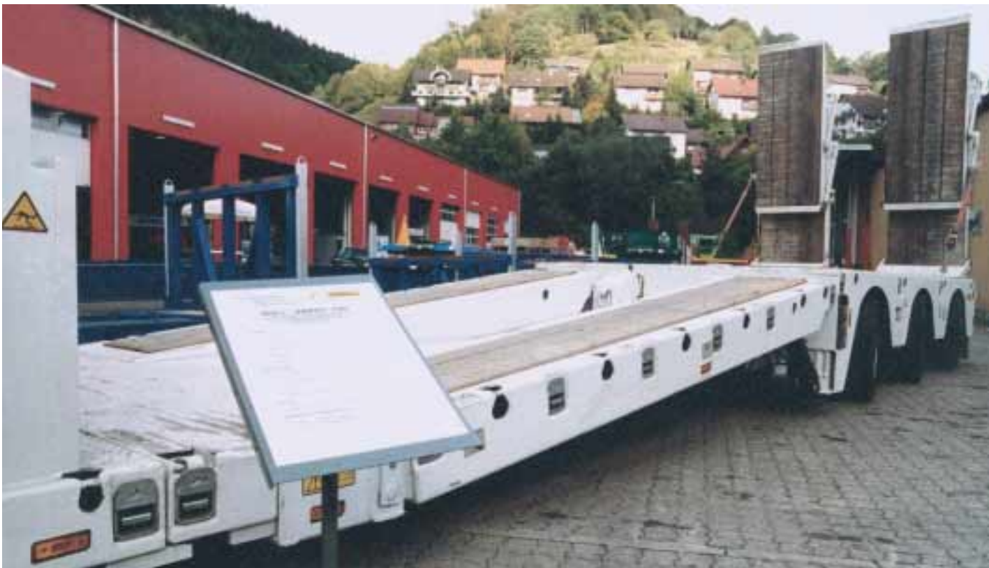
Ob mit bis auf Höhe der Achseinheit mittels der Funkfernsteuerung anhebbares Tiefbett, das so als Auffahrrampe dienen kann ...
