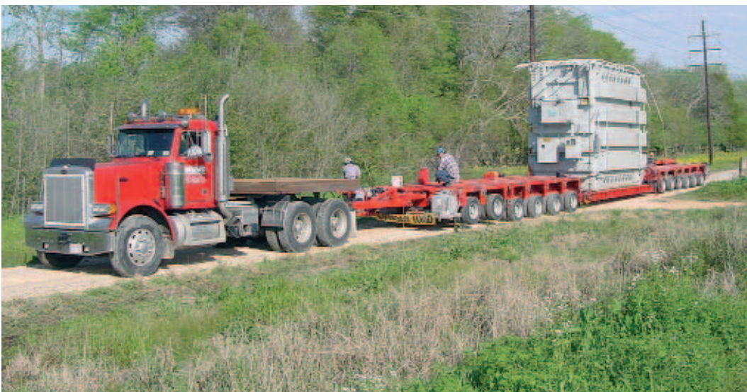
Die Goldhofer Schwerlastkombination bewies beim Transport des 90 t schweren Transformators aufgrund des hydraulischen Achsausgleichs auch Off-road-Qualitäten.
